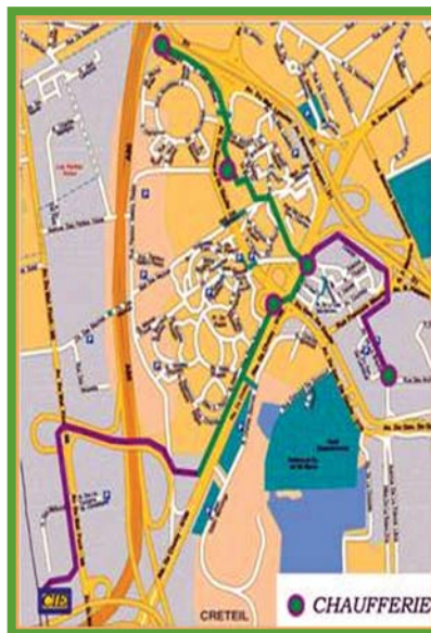
Liaison entre l'usine CIE et le réseau de chauffage urbain de Créteil
